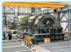
国内首台套十万等级空分装置用压缩机
